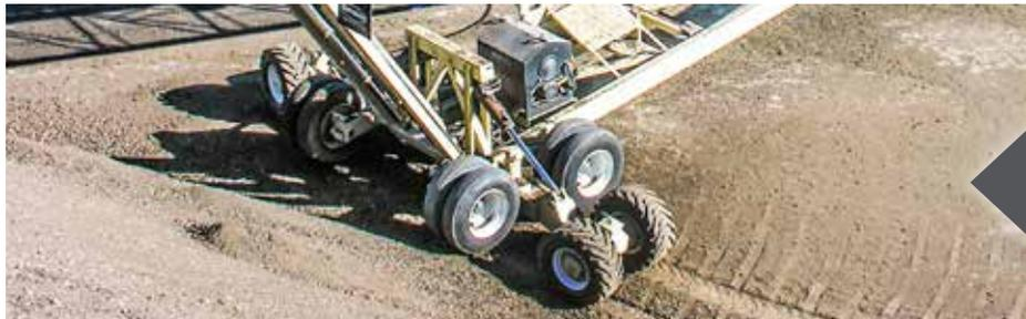
HYDRAULICALLY ADJUST TIRES TO OFFSET UNEVEN TERRAIN
